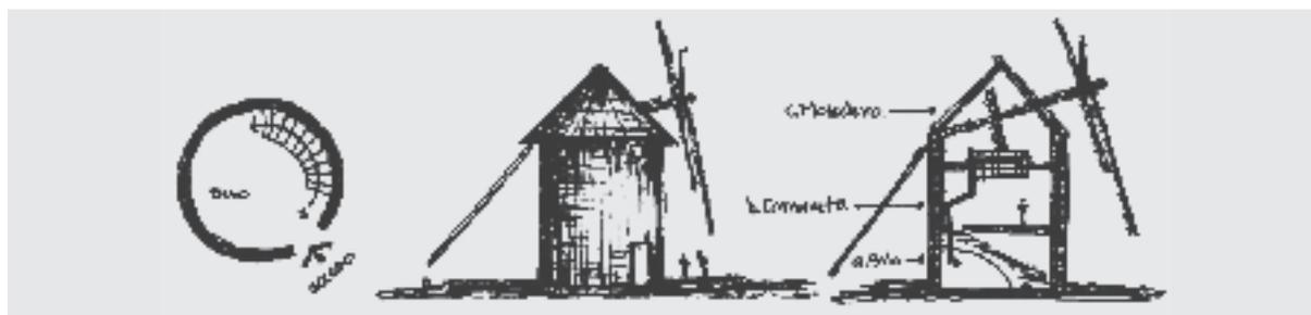
accesible para el funcionamiento de la maquinaria. En escaleras y puertas el material predominante era la madera. El sistema de molienda en si, estaba armado con piezas de madera, piedra y en algunas ocasiones se contaba con elementos de herrería. Todo este sistema implicaba que la construcción resistiera a los empujes tanto exteriores (viento) como interiores (maquinaria).
