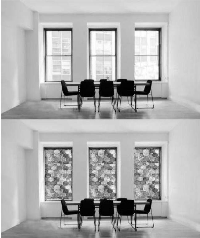
**Figura 2** Comparación entre ventanas tradicionales vs. inteligentes, cambiando su diseño transparente por uno con patrones en respuesta a estímulos del ambiente (Figura de elaboración propia).
