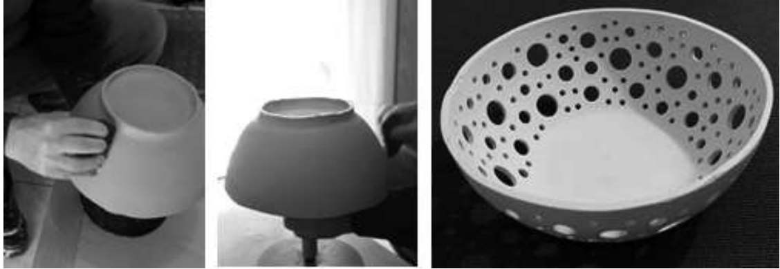
Figura 7 Izquierda y centro: Proceso de modelado de una vasija elaborada con la arcilla 13-2, se muestra su cualidad plástica para ser modelada con facilidad. Izquierda: aspecto de la pieza después de ser horneada en cono 8.
