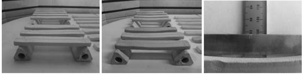
Figura 4 Izquierda: Probetas colocadas en el horno antes del ser horneadas. Centro: Probetas después del horneado, donde se aprecian los diferentes grados de deformación. Derecha: Medición.
