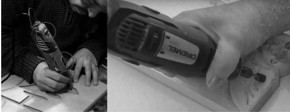
**Imagen 5a** Controles de velocidad y encendido inaccesibles durante uso. Paredes & Salazar (2018).
